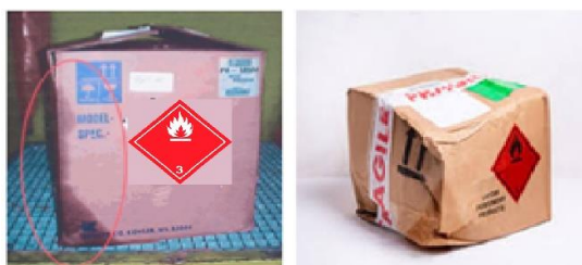
Şəkil 1. Zədələnmiş və sızmış təhlükəli yük
